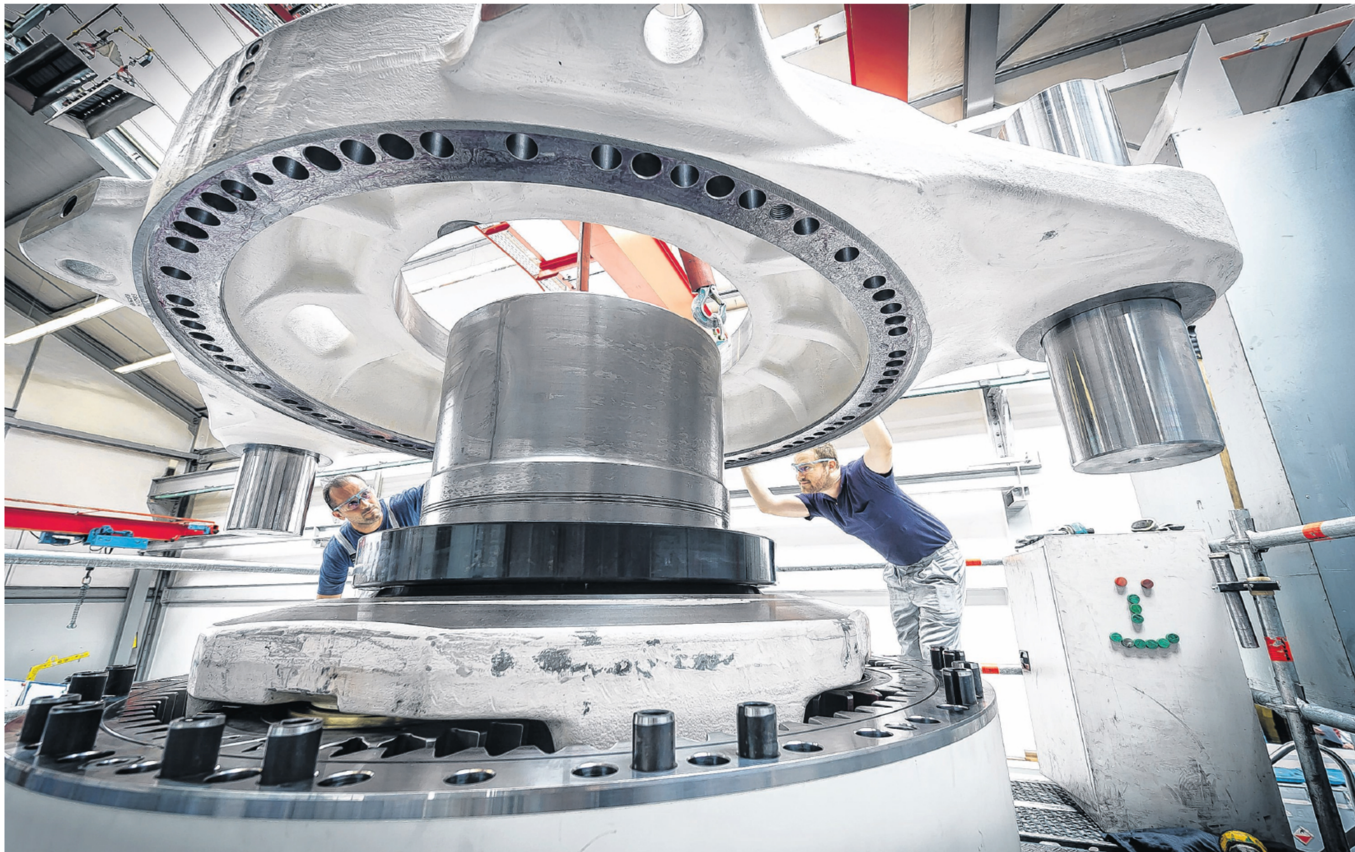
„Deckel drauf“: Lars Gleising und Pietro Raimondo bringen mit Hilfe eines Krans eine tonnenschwere „Planetensstufe“ eines Windkraftgetriebes an.
